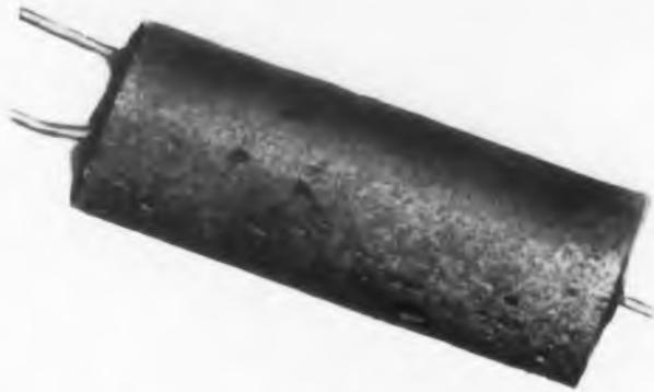
Fig. 1. Cylindrical bias supply shown actual size.
