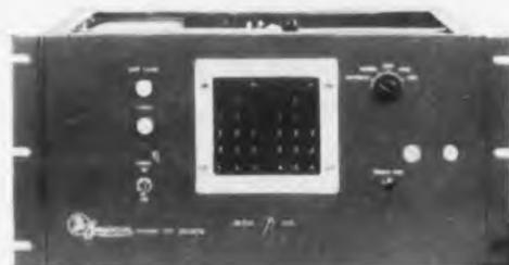
**NEW LIBRASCOPE PUNCHED TAPE CONVERTER**
